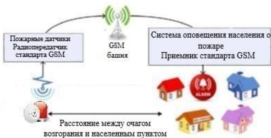
Рис. 3. Информационная система обнаружения пожара в лесных массивах и оповещения населения с использованием сети сотовой связи стандарта GSM
