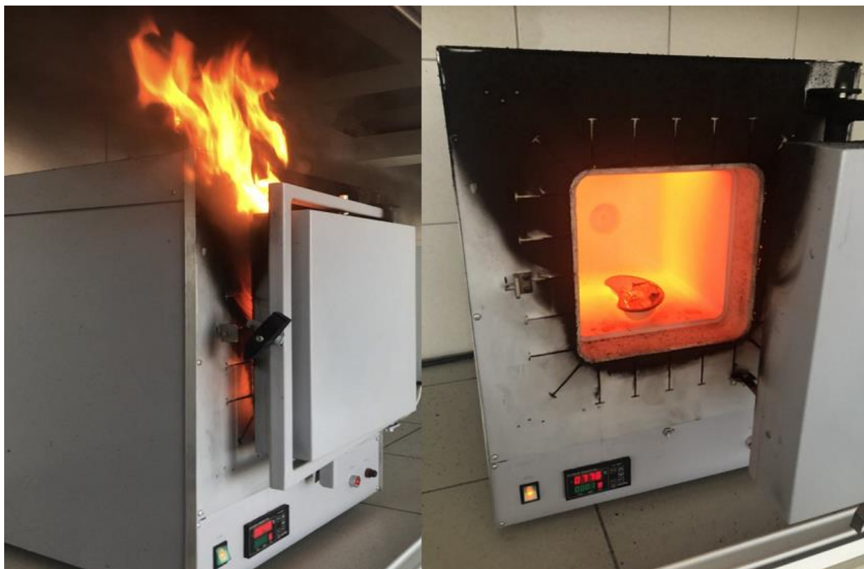
Рис. 1. Проведение исследования термического воздействия органических полимерных строительных материалов
