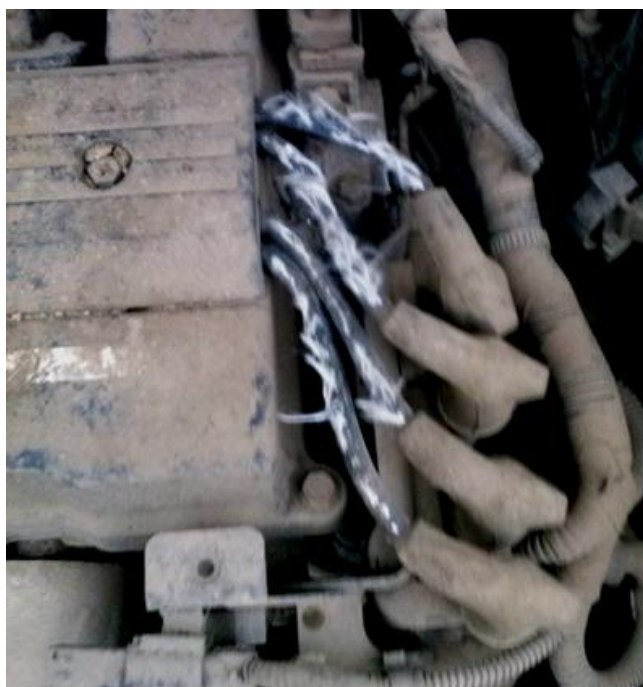
Рис. 3. Поврежденная крысами изоляция высоковольтной проводки автомобиля ВАЗ
