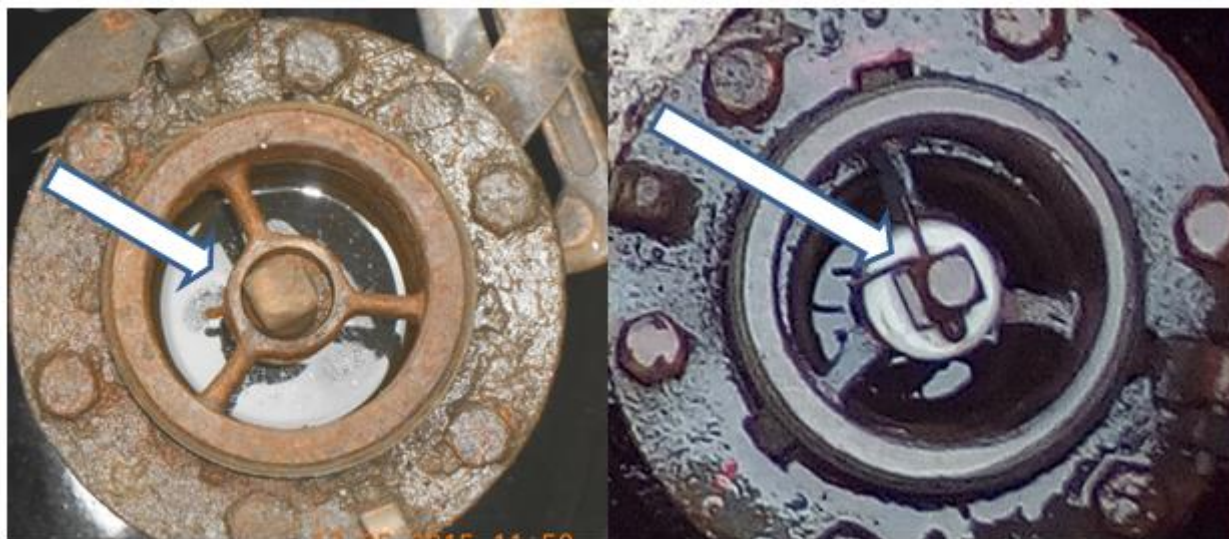
Рис. 6. Размещение шпильки удерживающей шпindelь
