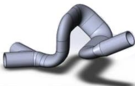
Рис. 2. Структура дальнобойного лафетного пожарного ствола с винтовой структуризацией потолка в проточной части
